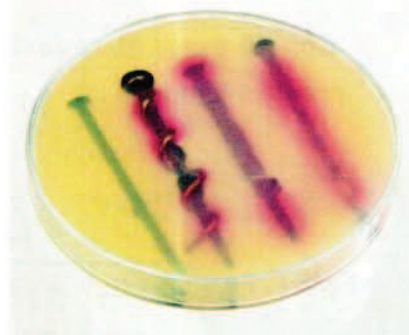
Doc 4. Au bout de quelques minutes à quelques heures, les zones de corrosion apparaissent.
